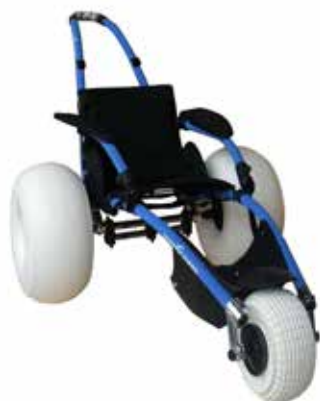
Ballonghjul, super løsning for mykt underlag!
