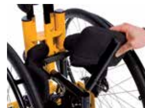
Avtagbar hoftestøtte, forenkler forflytning (standard)
