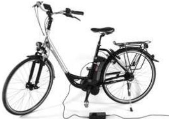
BATTERIET PÅ SETERØRET Lading av batteriet
